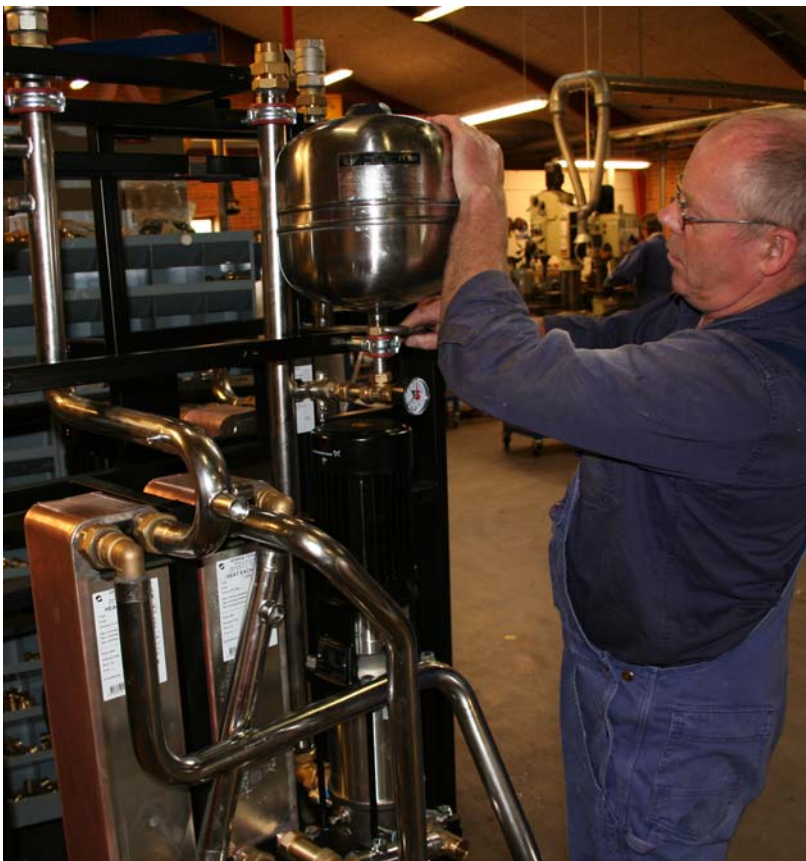
Bo Rasmussen i gang med at lægge sidste hånd på en køleunit til sendestationen i Hedensted.
